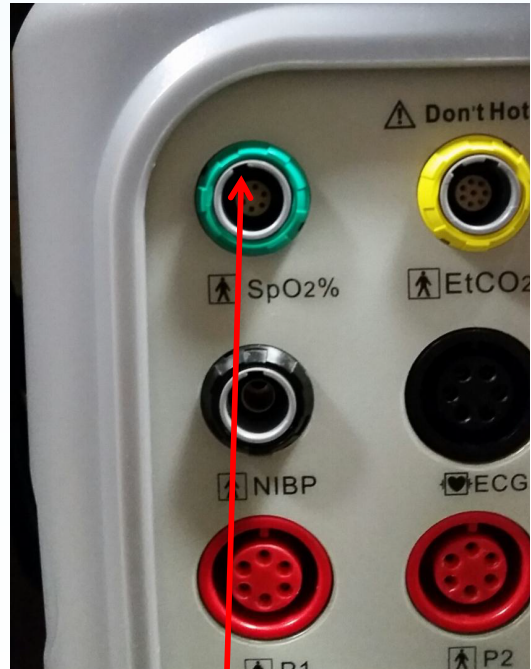
Analog or Nellcor SpO2 Monitors - 1 Keyway Guide; 6 pins
