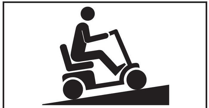
Figura 4. Posición de conducción de mayor estabilidad
