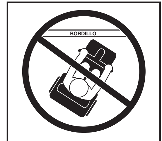
Figura 7. Modo incorrecto de subir/bajar un cordón
