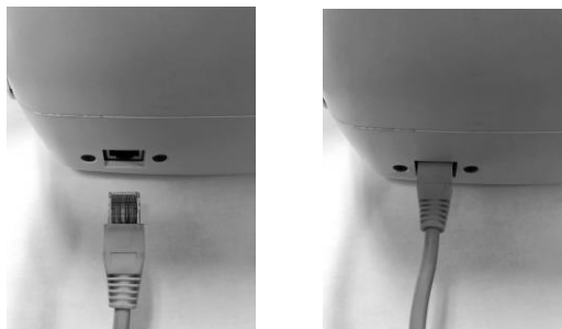
Illustration 3 : Connecteur de la commande manuelle avec la languette de verrouillage insérée à l'intérieur du connecteur du lève-personne
